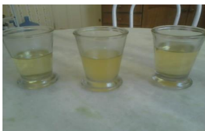
Figura 3. Recipiente à esquerda contém óleo de soja limpo, recipiente no meio óleo residual de fritura, recipiente a direita é óleo depois da primeira decantação.
