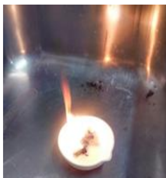
Figura 4). Teste de combustão com algodão imerso no biodiesel puro.
