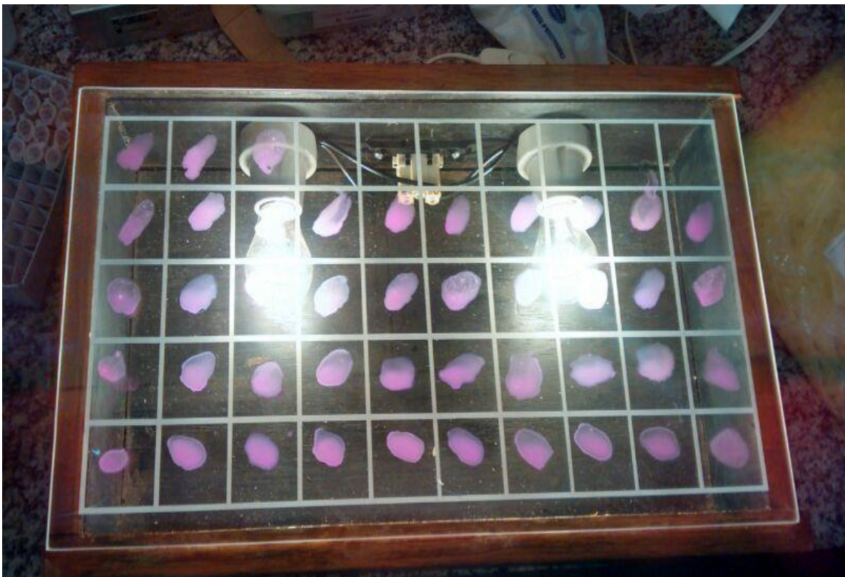
Figura 1. Imunoaglutinação em placa com antígeno acidificado tamponado (AAT) com rosa Bengala, empregando antígeno preparado com Brucella abortus .
