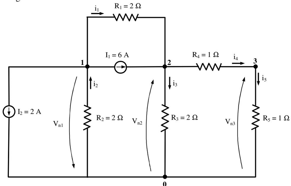
Fig. 7.21 - Indicação das correntes  $i_1$  e  $i_4$  nos resistores  $R_1$  e  $R_4$ , respectivamente
