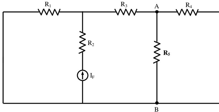
Fig. 9.4 - Circuito sem a fonte  $V_F$
