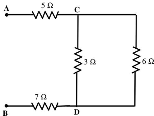
Fig. 6.17 - Circuito equivalente após a substituição dos resistores de 1 Ω e do resistor de 4 Ω por um resistor equivalente de 6 Ω
