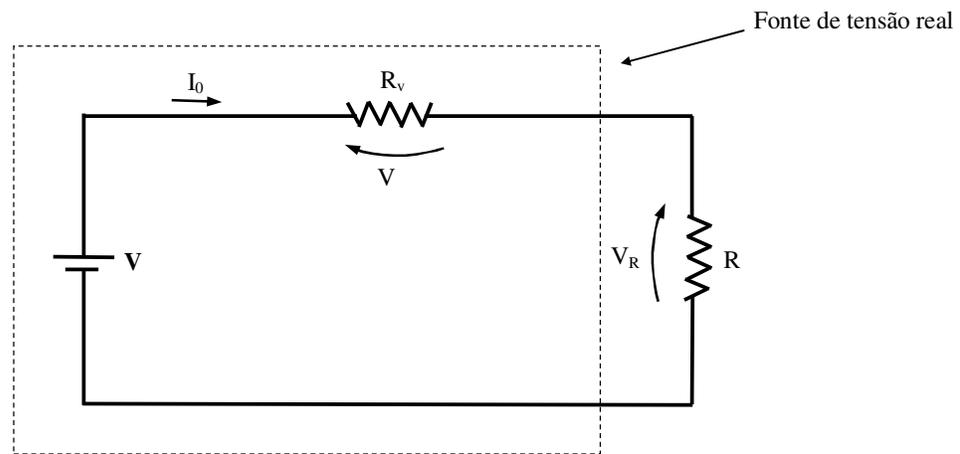
Fig. 11.1 – Fonte de tensão alimentando uma carga resistiva
