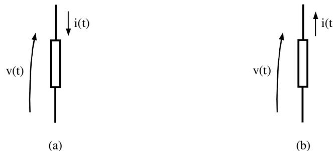
Fig. 4.1 - Bipolos com suas respectivas tensões e correntes
