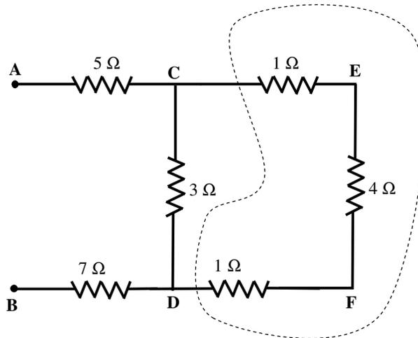
Fig. 6.16 - Resistores de 1 Ω e resistor de 4 Ω conectados em série
