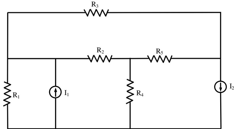
Fig. 7.11 - Circuito alimentado por duas fontes de corrente
