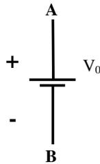
Fig. 2.2 - Representação de uma fonte de tensão  $V_0$  constante
