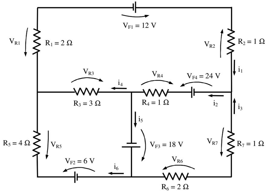
Fig. 7.8 - Correntes e tensões no circuito
