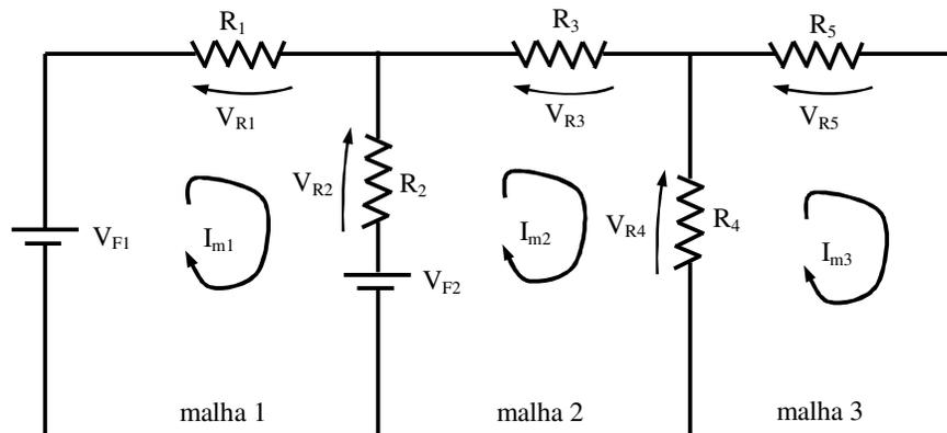
Fig. 7.4 - Tensões nos resistores em função das correntes de malha
