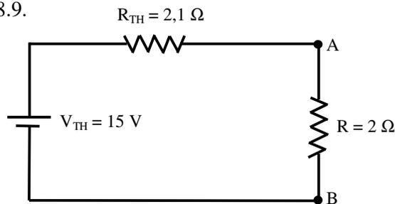
Fig. 8.9 - Circuito equivalente de Thévenin para o circuito mostrado na Fig. 8.5
