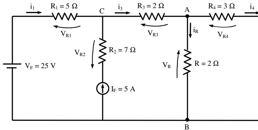
Fig. 8.6 - Escolha das correntes e tensões no circuito do exemplo 8.1
