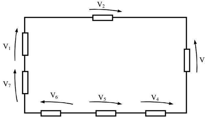
Fig. 5.4 - Malha com seus bipolos e as respectivas tensões
