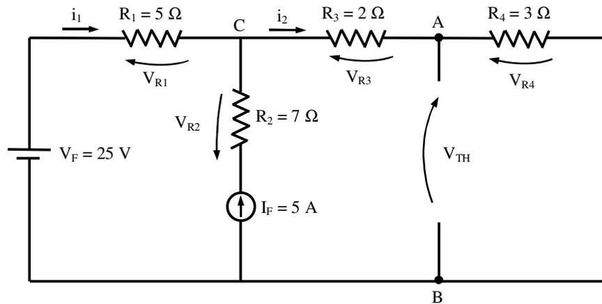
Fig. 8.7 - Escolha das correntes e tensões no circuito do exemplo 8.1
