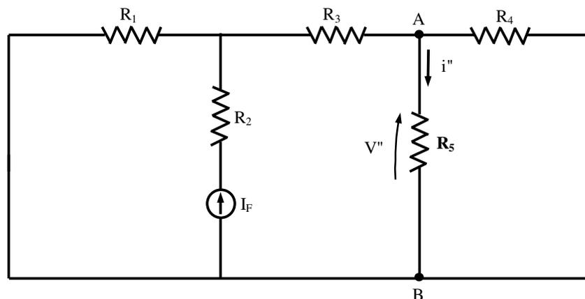
Fig. 9.5 - Corrente e tensão em  $R_5$  devido à fonte de corrente  $I_F$
