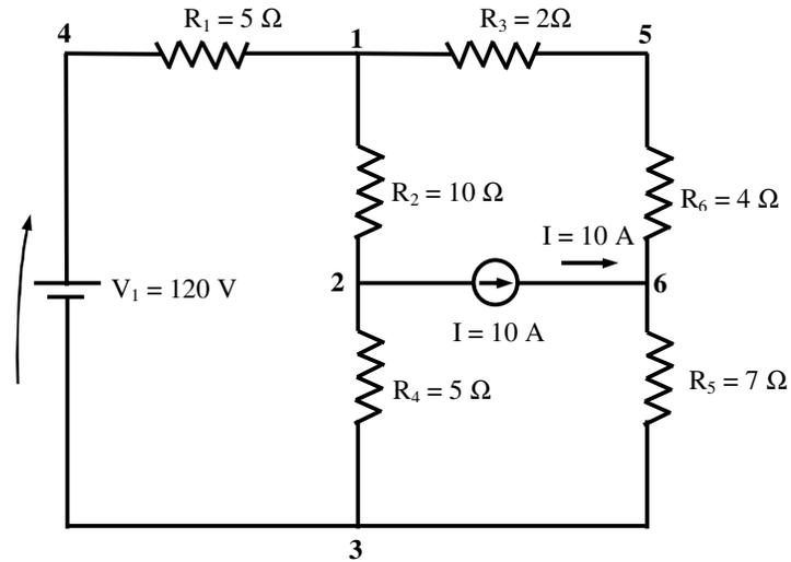
Fig. 5.6 - Circuito com a tensão  $V_1$  e com a corrente  $I$
