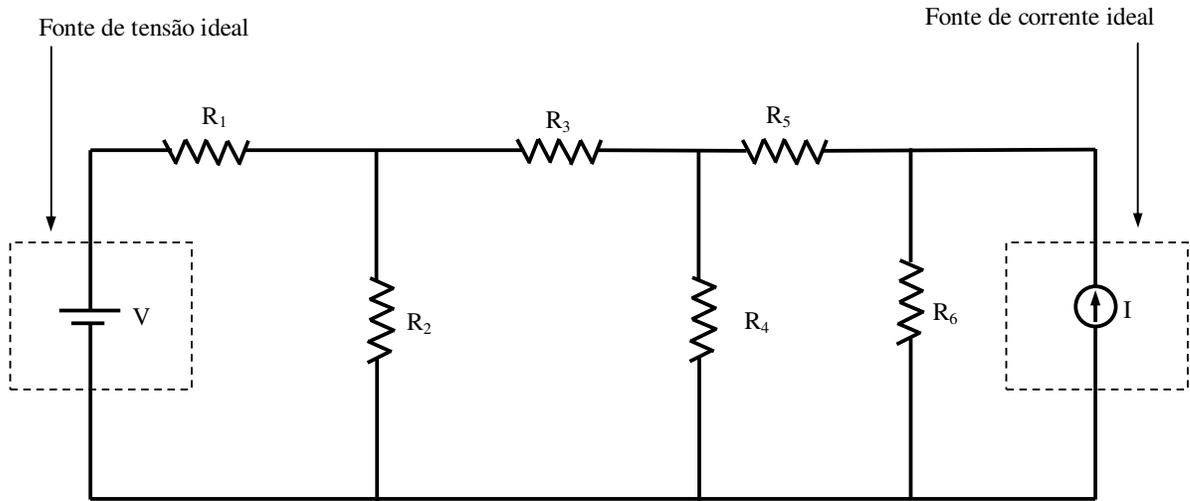
Fig. 11.9 – Circuito alimentado por fontes de tensão e de corrente
