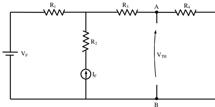
Fig. 8.3 - Tensão de Thévenin no circuito mostrado na Fig. 8.1
