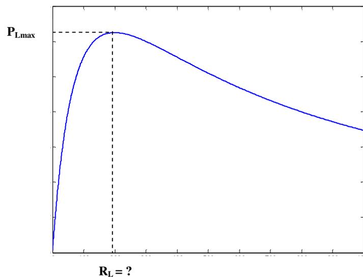
Fig. 10.2 - Potência fornecida para a carga em função de sua resistência  $R_L$
