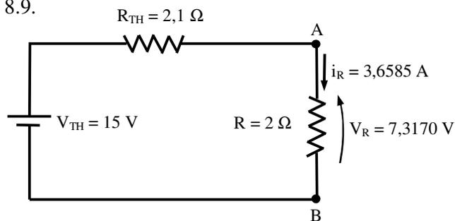
Fig. 8.10 - Correntes e tensões no resistor R, no circuito mostrado na Fig. 8.5, obtidas a partir do teorema de Thévenin
