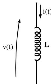
Fig. 2.12 - Representação de um indutor  $L$  submetido a uma tensão  $v(t)$  e percorrido por uma corrente  $i(t)$
