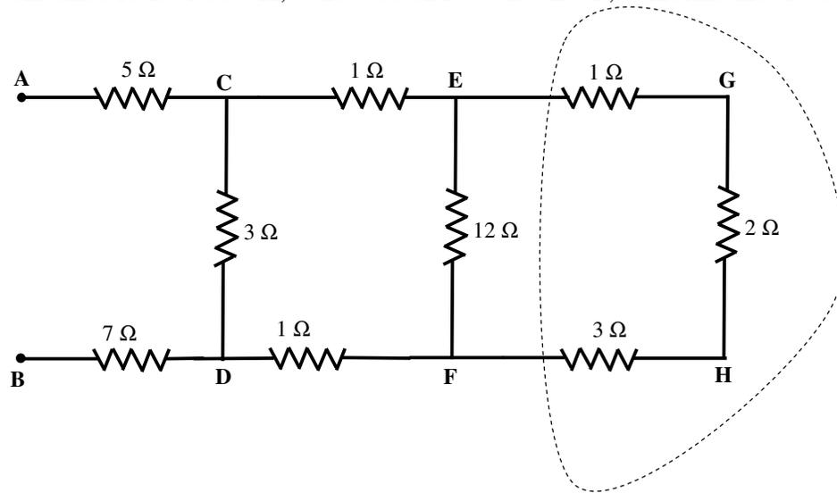
Fig. 6.12 - Resistores de  $1\ \Omega$ ,  $2\ \Omega$  e de  $3\ \Omega$  conectados em série
