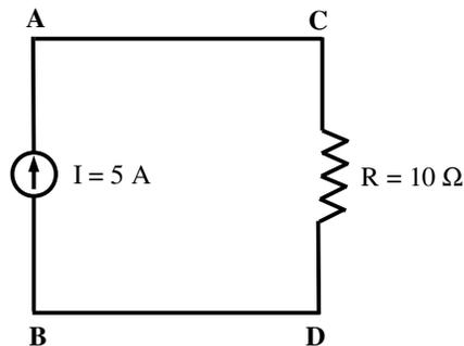
Fig. 3.7 - Fonte de corrente I alimentando um Resistor R
