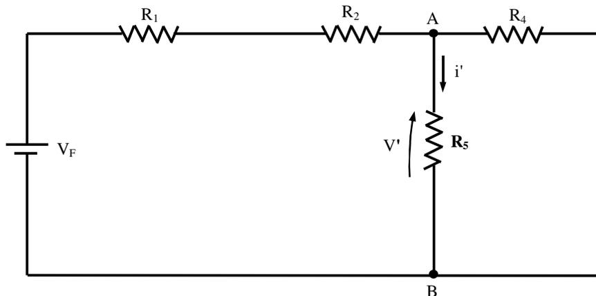
Fig. 9.3 - Corrente e tensão em  $R_5$  devido à fonte de tensão  $V_F$
