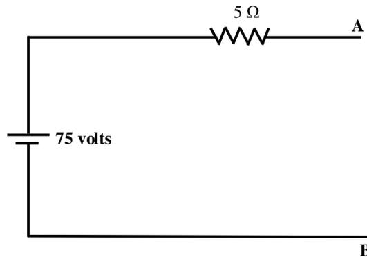
Fig. 11.8 – Fonte de tensão equivalente à fonte de corrente mostrada na Fig. 11.7
