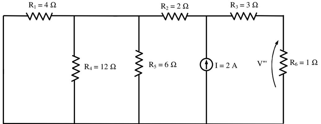
Fig. 9.9 - Contribuição da fonte de corrente para a tensão sobre  $R_6$
