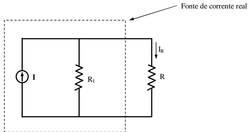
Fig. 11.2 – Fonte de corrente alimentando uma carga resistiva
