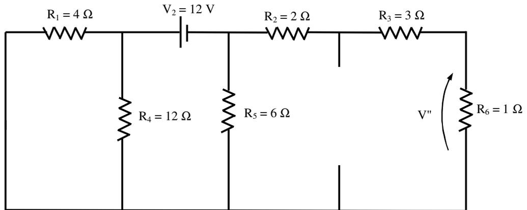
Fig. 9.8 - Contribuição da fonte de tensão  $V_2$  para a tensão sobre  $R_6$
