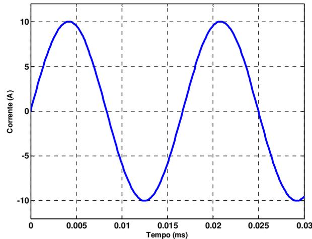
Fig. 1.2 - Corrente alternada com forma de onda senoidal
