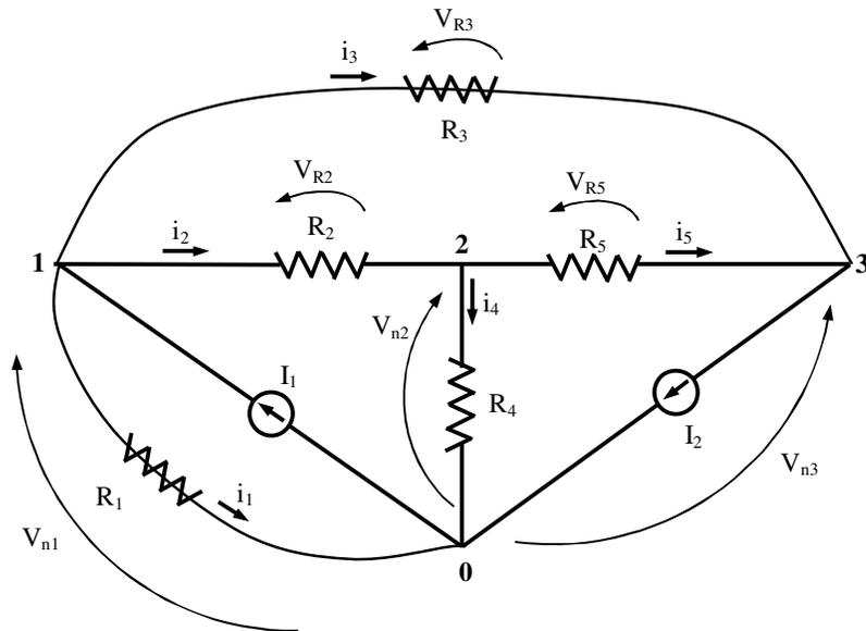
Fig. 7.16 - Circuito com as correntes e tensões nos resistores
