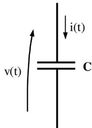
Fig. 2.14 - Representação de um capacitor  $C$  submetido a uma tensão  $v(t)$  e percorrido por uma corrente  $i(t)$
