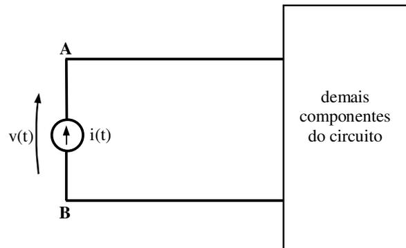
Fig. 2.7 - fonte de corrente fornecendo energia para o circuito
