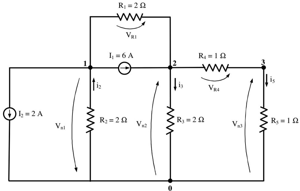
Fig. 7.23 - Indicação das tensões em  $R_1$  e  $R_4$
