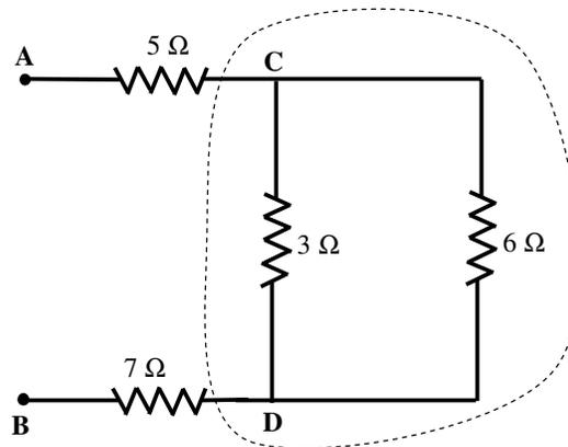
Fig. 6.18 - Resistores de 3 Ω e de 6 Ω conectados em paralelo
