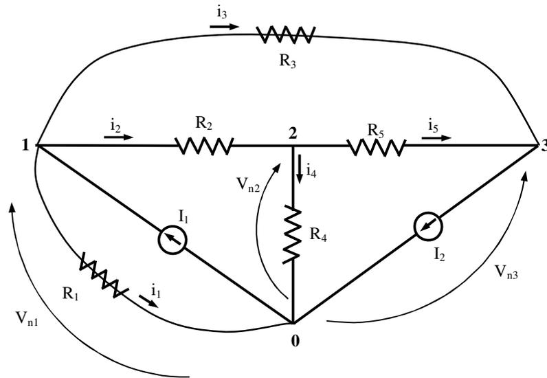
Fig. 7.15 - Circuito com as correntes nos resistores
