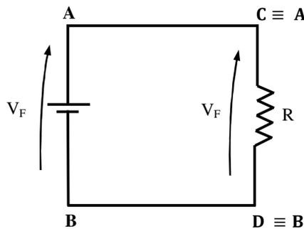
Fig. 3.5 - Identificação da tensão no resistor R
