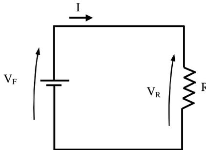
Fig. 4.4 - Circuito referente ao exemplo 4.1: indicação das tensões e da corrente
