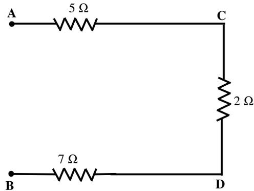
Fig. 6.19 - Circuito equivalente após a substituição dos resistores de 3 Ω e de 6 Ω por um resistor equivalente de 2 Ω
