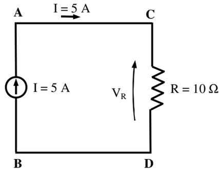
Fig. 3.8 - Corrente e tensão no resistor R
