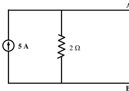
Fig. 11.6 – Fonte de corrente equivalente à fonte de tensão mostrada na Fig. 11.5
