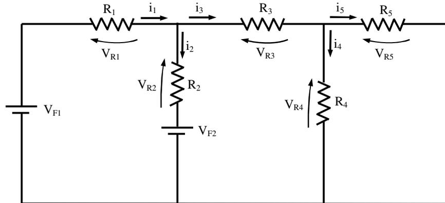
Fig. 7.5 - Tensões e correntes nos bipolos do circuito
