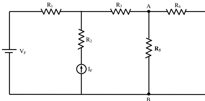
Fig. 9.1 - Circuito para explicação do teorema da superposição
