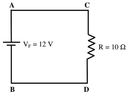
Fig. 3.2 - Fonte de tensão  $V_F$  alimentando um Resistor  $R$
