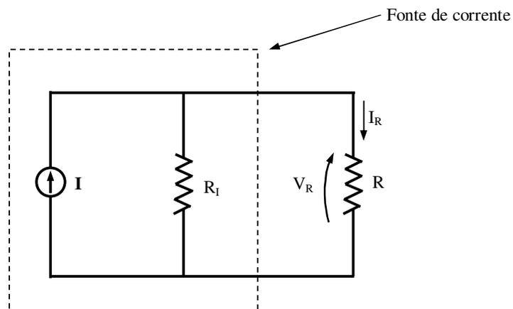
Fig. 11.4 – Carga  $R$  alimentada por uma fonte de corrente
