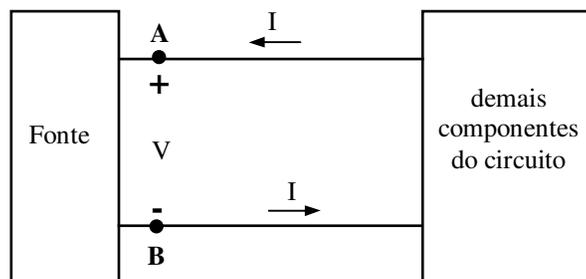
Fig. 1.4 - Fonte de tensão recebendo energia dos demais componentes do circuito
