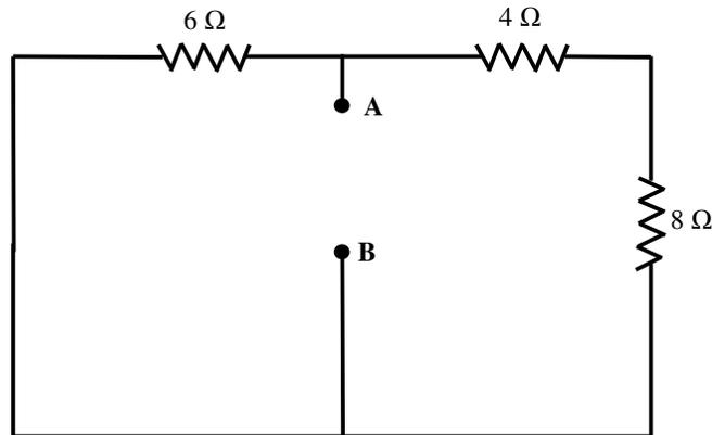
Fig. 10.4 - Circuito para o cálculo da resistência de Thévenin
