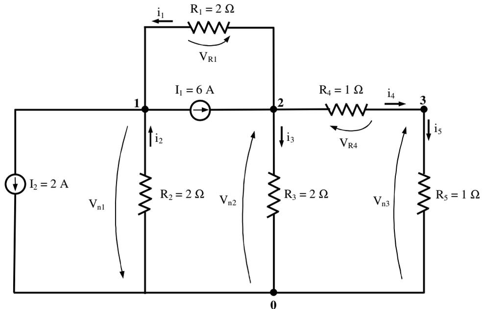
Fig. 7.24 - Correntes e tensões em  $R_1$  e  $R_4$
