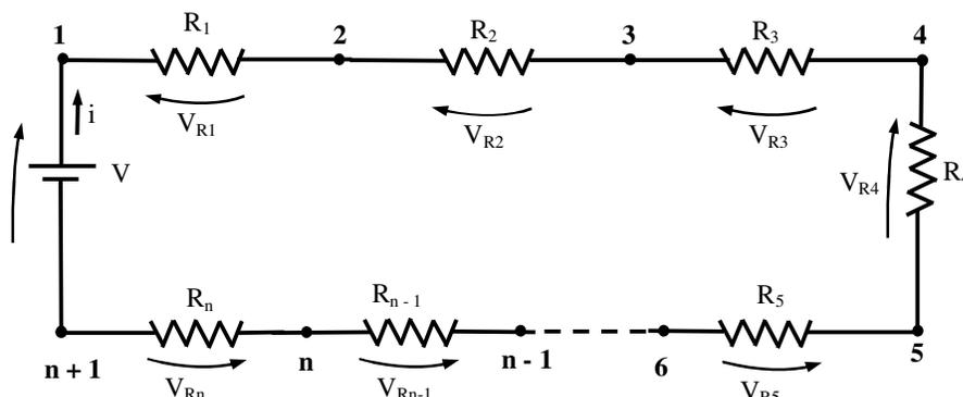
Fig. 6.2 - Corrente e tensões em um circuito com  $n$  resistores conectados em série
