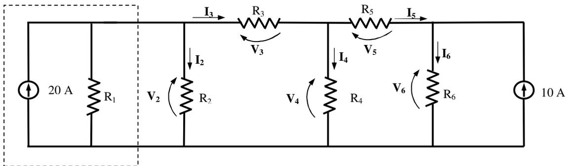
Fig. 11.15 – Circuito da Fig. 11.13 após a transformação da fonte de tensão em fonte de corrente
