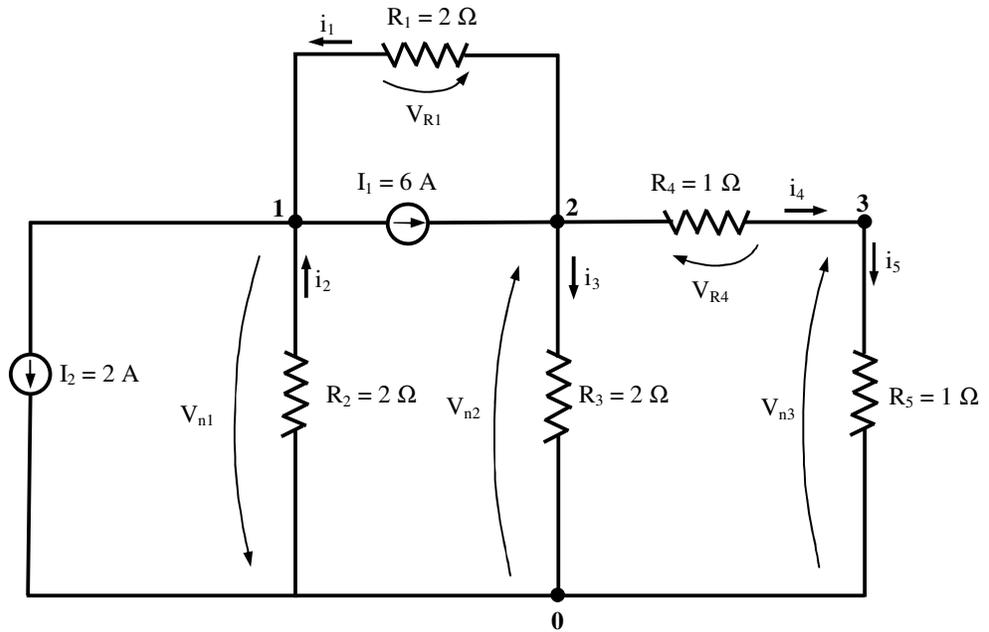
Fig. 7.25 - Correntes e tensões em todos os bipolos
