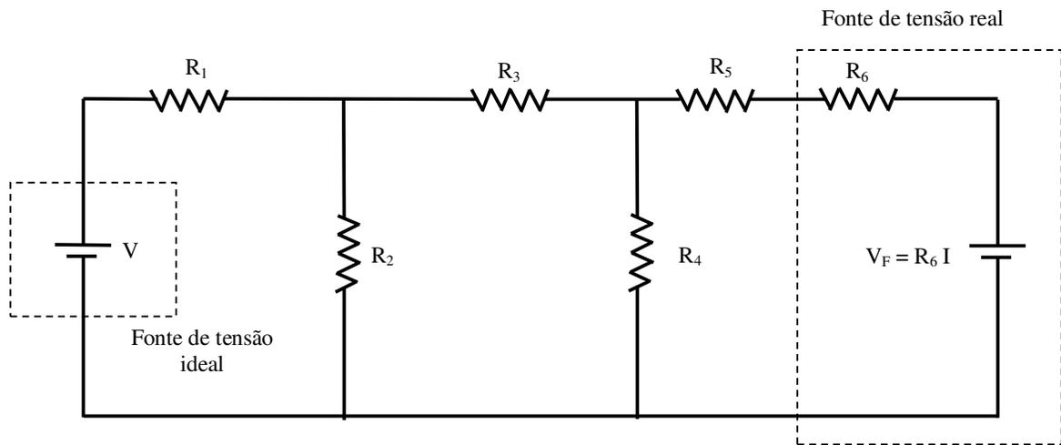
Fig. 11.11 – Circuito da Fig. 11.9 considerando que a fonte de corrente foi transformada em uma fonte de tensão
