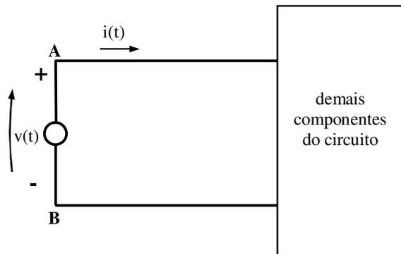
Fig. 2.3 - fonte de tensão fornecendo energia para o circuito
