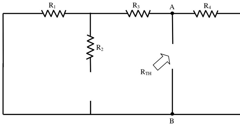
Fig. 8.4 - Resistência de Thévenin no circuito mostrado na Fig. 8.1
