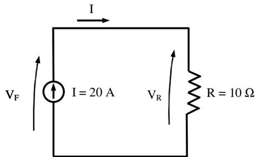
Fig. 4.6 - Circuito referente ao exemplo 4.2: indicação das tensões e da corrente
