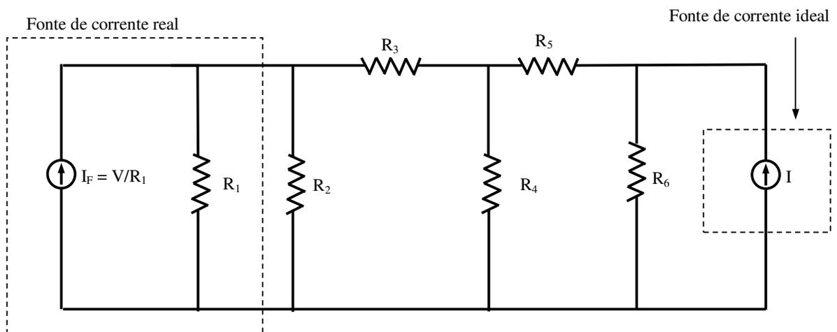
Fig. 11.12 – Circuito da Fig. 11.9 considerando que a fonte de tensão foi transformada em uma fonte de corrente
