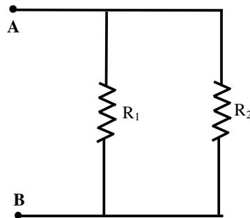
Fig. 6.9 - Associação de dois resistores em paralelo
