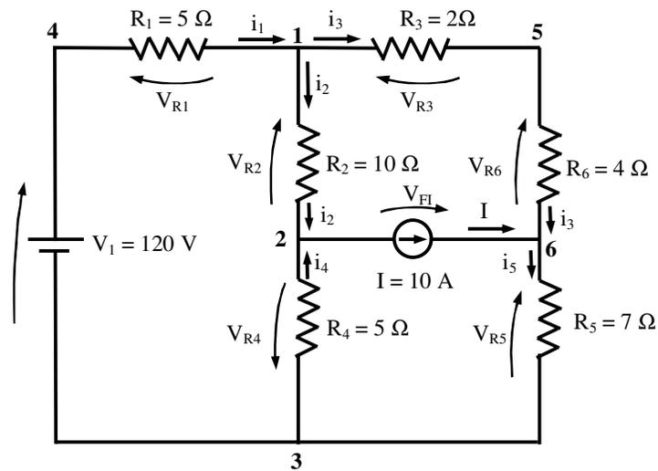
Fig. 5.8 - Tensões e corrente no circuito
