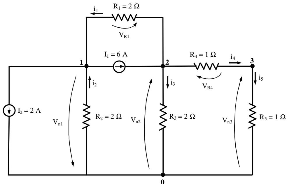
Fig. 7.22 - Correntes e tensões em  $R_1$  e  $R_4$
