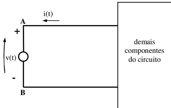
Fig. 2.4 - fonte de tensão recebendo energia do circuito
