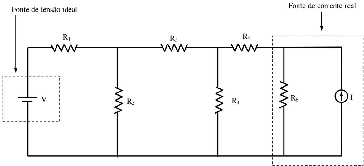
Fig. 11.10 – Circuito com fonte de corrente real
