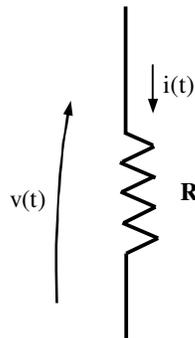
Fig. 3.1 - Resistor  $R$  submetido a uma tensão  $v(t)$  e percorrido por uma corrente  $i(t)$
