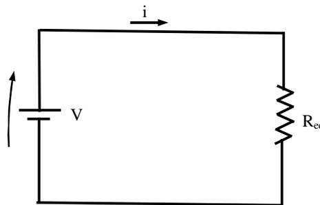
Fig. 6.3 - Circuito equivalente ao circuito da Fig. 6.1
