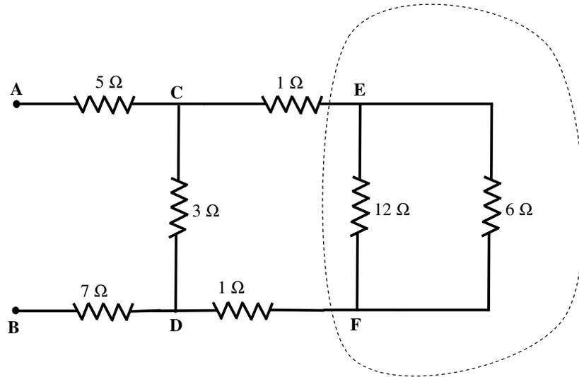
Fig. 6.14 - Resistores de 12 Ω e de 6 Ω conectados em paralelo
