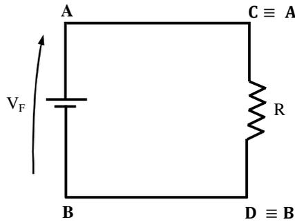
Fig. 3.4 - Indicação dos pontos coincidentes no circuito
