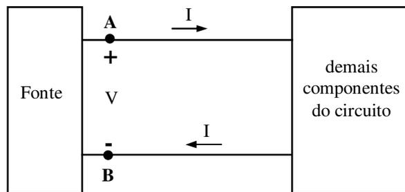
Fig. 1.3 - Fonte de tensão fornecendo energia para os demais componentes do circuito
