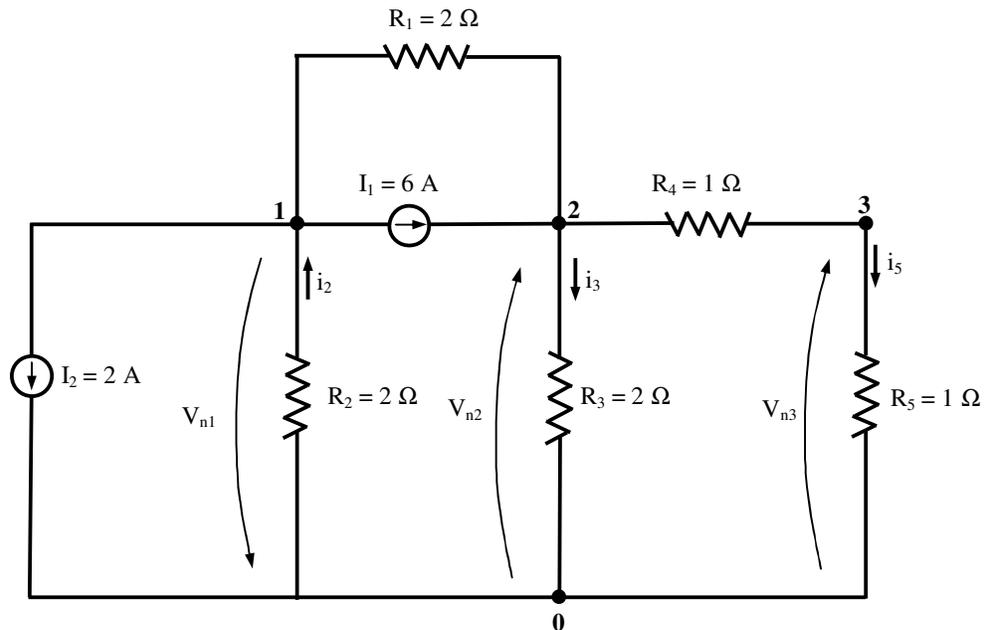
Fig. 7.20 - Correntes  $i_2$ ,  $i_3$  e  $i_5$  nos resistores  $R_2$ ,  $R_3$  e  $R_5$ , respectivamente
