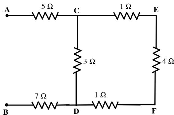
Fig. 6.15 - Circuito equivalente após a substituição dos resistores de 12 Ω e de 6 Ω por um resistor equivalente de 4 Ω
