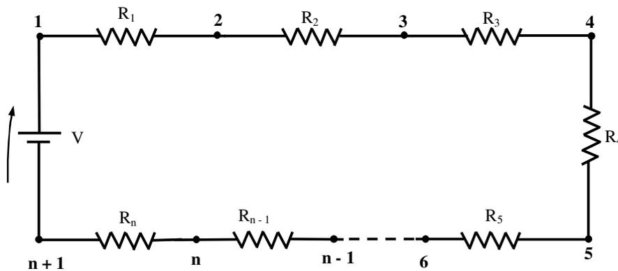
Fig. 6.1 - Circuito com  $n$  resistores conectados em série
