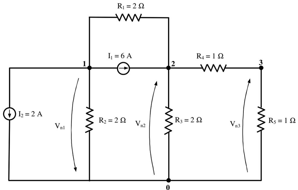
Fig. 7.19 - Circuito com as respectivas tensões de nós
