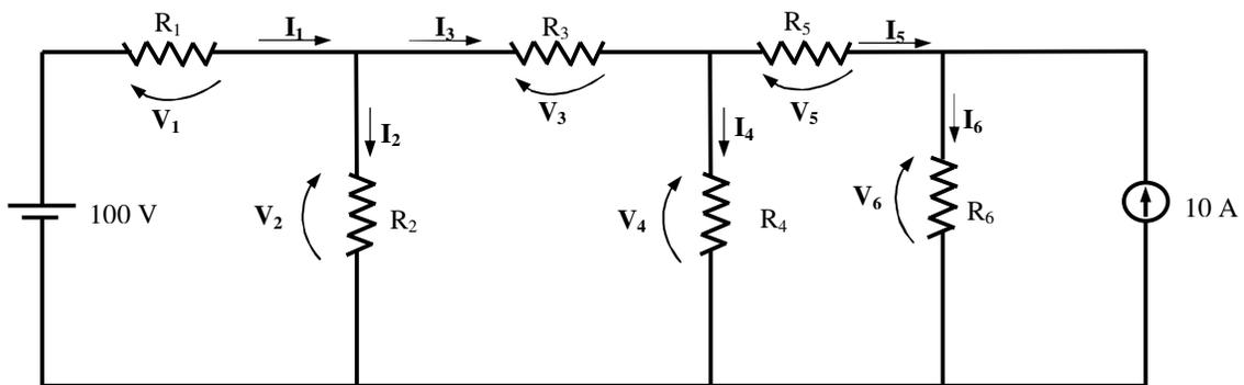
Fig. 11.13 – Indicação das correntes e tensões em todos os bipolos do circuito mostrado na Fig. 11.9
