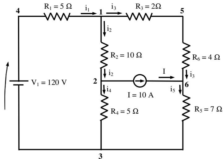
Fig. 5.6 - "Chute" das correntes nos  $n-1$  nós com 3 ou mais bipolos conectados
