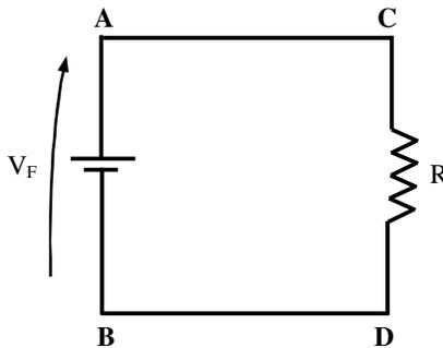
Fig. 3.3 - Direção da tensão  $V_F$  no circuito
