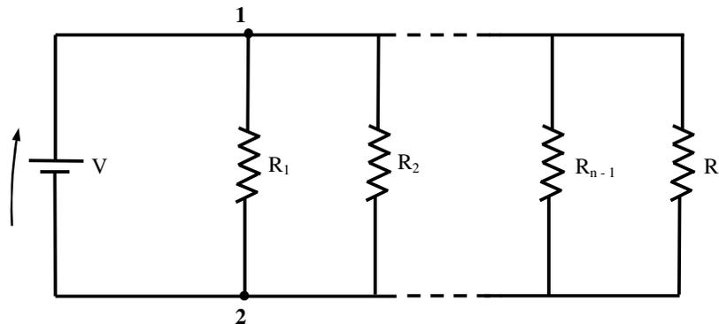
Fig. 6.4 - Circuito com  $n$  resistores conectados em paralelo
