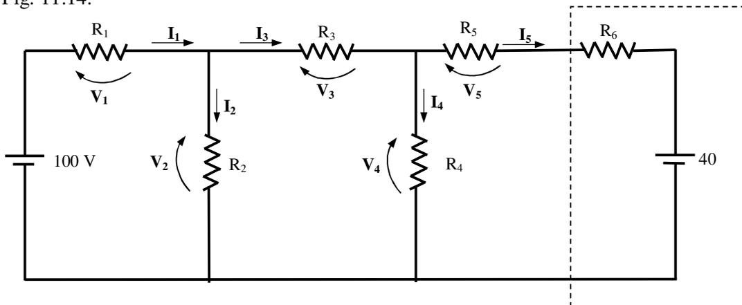
Fig. 11.14 – Circuito da Fig. 11.13 após a transformação da fonte de corrente em fonte de tensão
