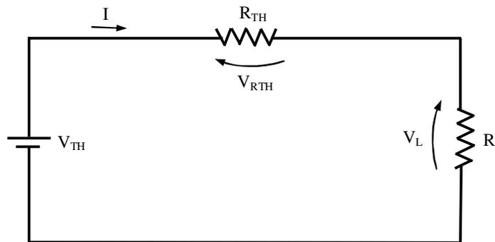
Fig. 10.1 - Circuito equivalente de Thévenin alimentando uma carga resistiva  $R_L$
