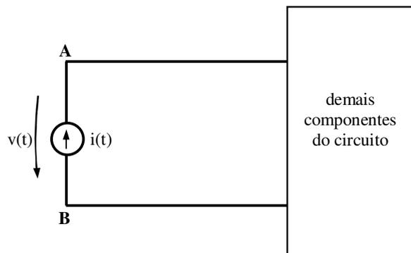
Fig. 2.8- fonte de corrente recebendo energia do circuito
