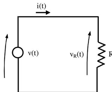
Fig. 4.2 - Fonte  $v(t)$  alimentando um resistor  $R$
