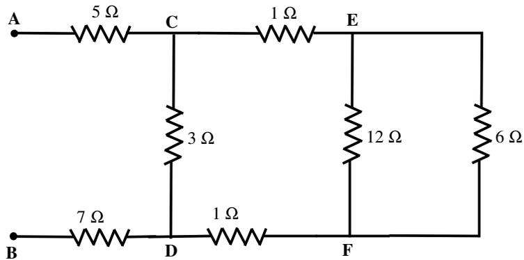
Fig. 6.13 - Circuito equivalente após a substituição dos resistores de  $1\ \Omega$ ,  $2\ \Omega$  e de  $3\ \Omega$  por um resistor equivalente de  $6\ \Omega$
