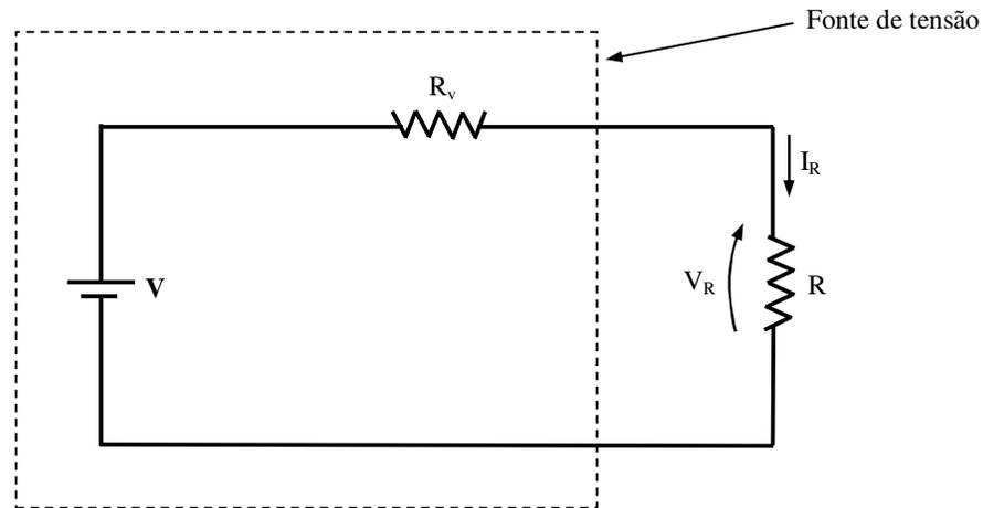
Fig. 11.3 – Carga  $R$  alimentada por uma fonte de tensão
