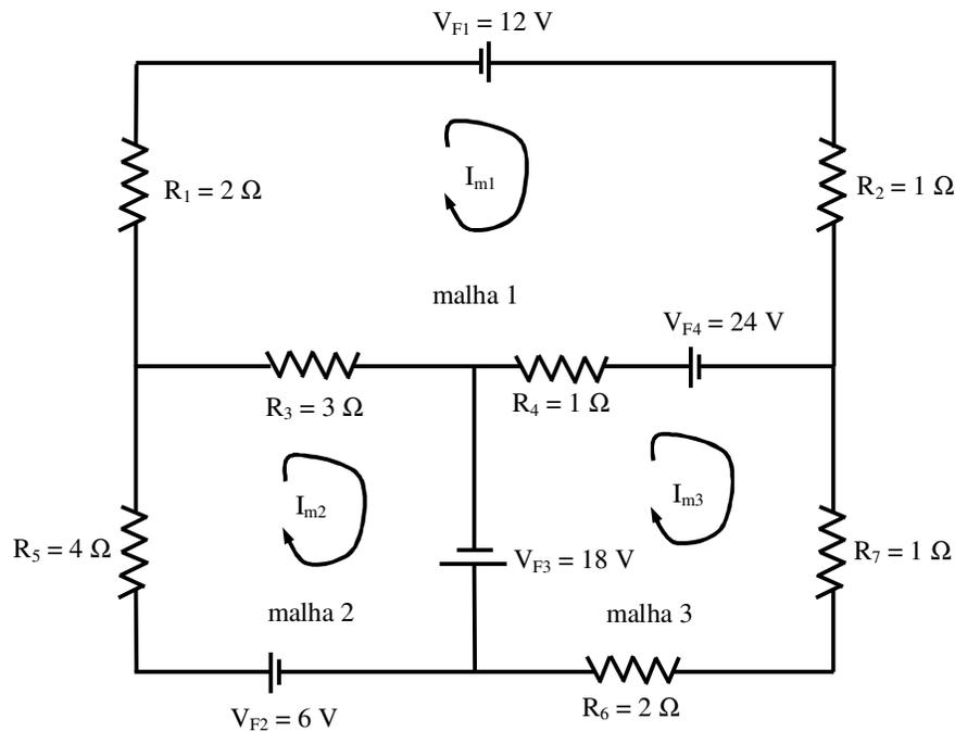
Fig. 7.7 - identificação das malhas e das correntes de malha no circuito
