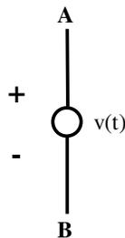
Fig. 2.1 - Representação de uma fonte de tensão  $v(t)$  variável no tempo
