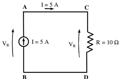
Fig. 3.9 - Corrente e tensões no circuito
