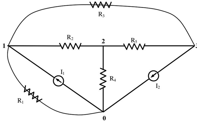
Fig. 7.13 - Identificação dos nós do circuito
