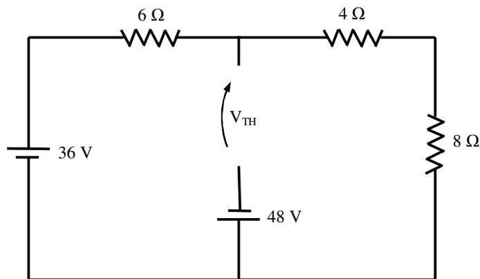
Fig. 10.3 - Circuito para o cálculo da tensão de Thévenin
