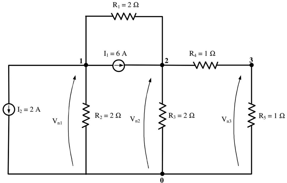
Fig. 7.18 - Indicação das tensões de nós
