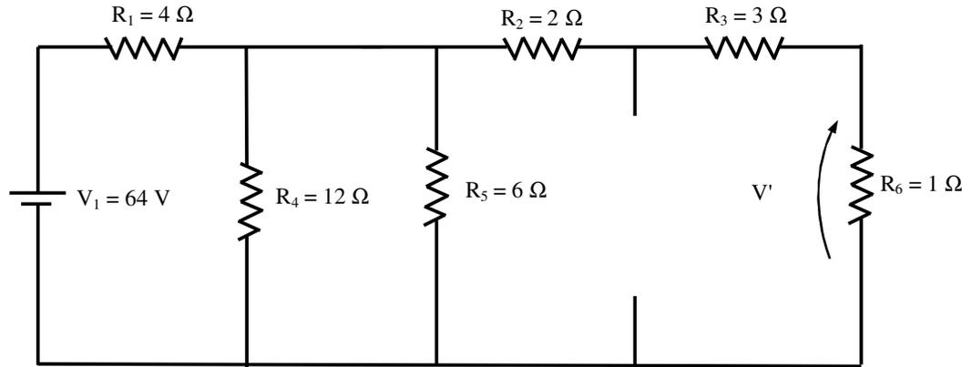
Fig. 9.7 - Contribuição da fonte de tensão  $V_1$  para a tensão sobre  $R_6$
