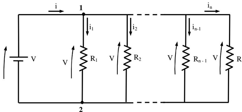
Fig. 6.5 - Correntes e tensões em um circuito com  $n$  resistores conectados em paralelo
