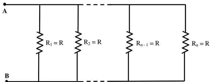
Fig. 6.7 - Associação em paralelo de n resistores idênticos iguais
