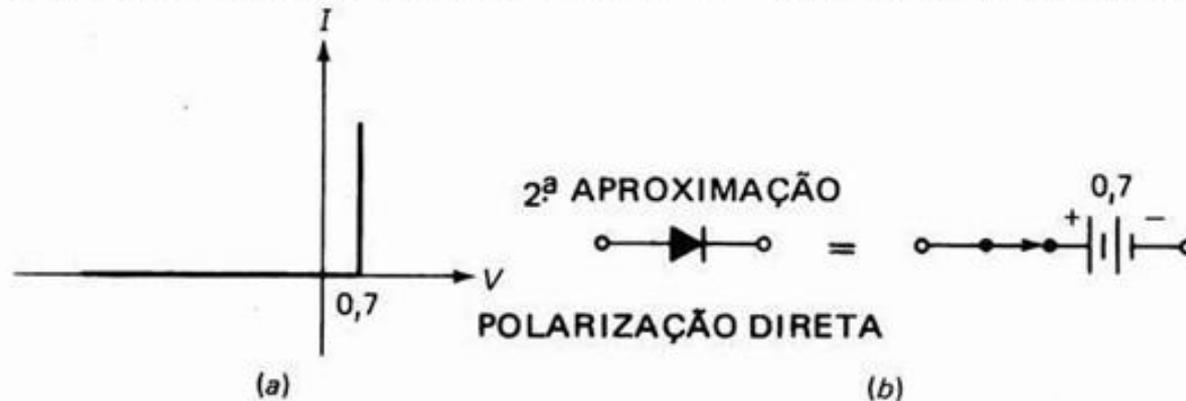
Fig. 2-21 (a) Segunda aproximação. (b) A chave e a bateria formam o circuito equivalente.
