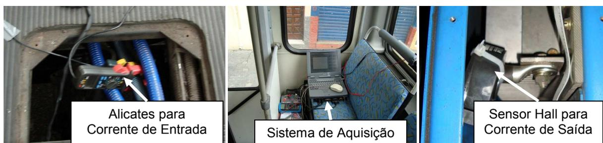
Figura 5.25: Fotos do sistema de aquisição de dados.
