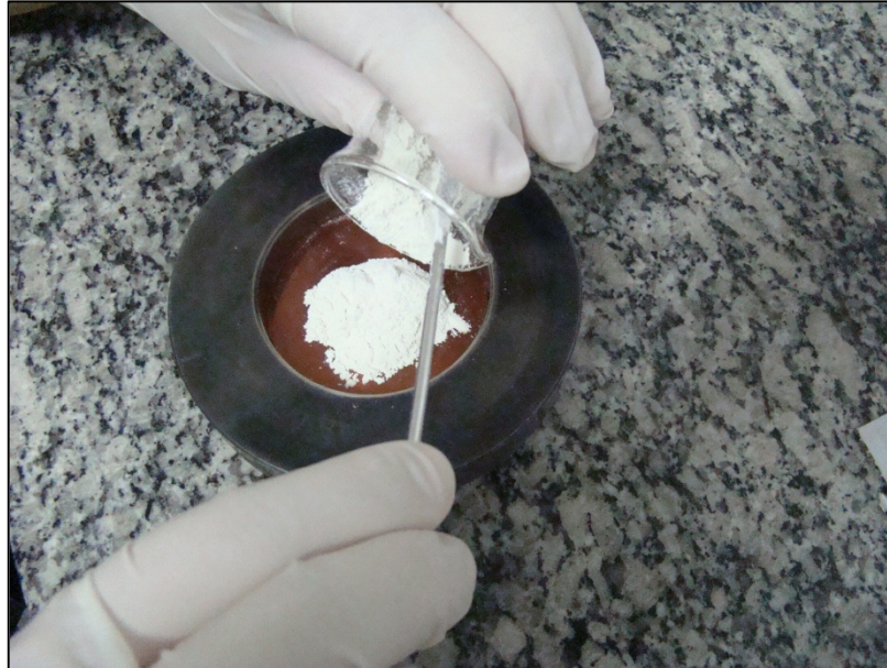
Figura 3.3 - Colocação da mistura de PZT/PVDF no molde.
