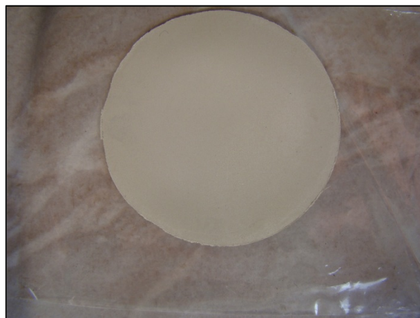
Figura 3.6 - Compósito retirado do molde.
