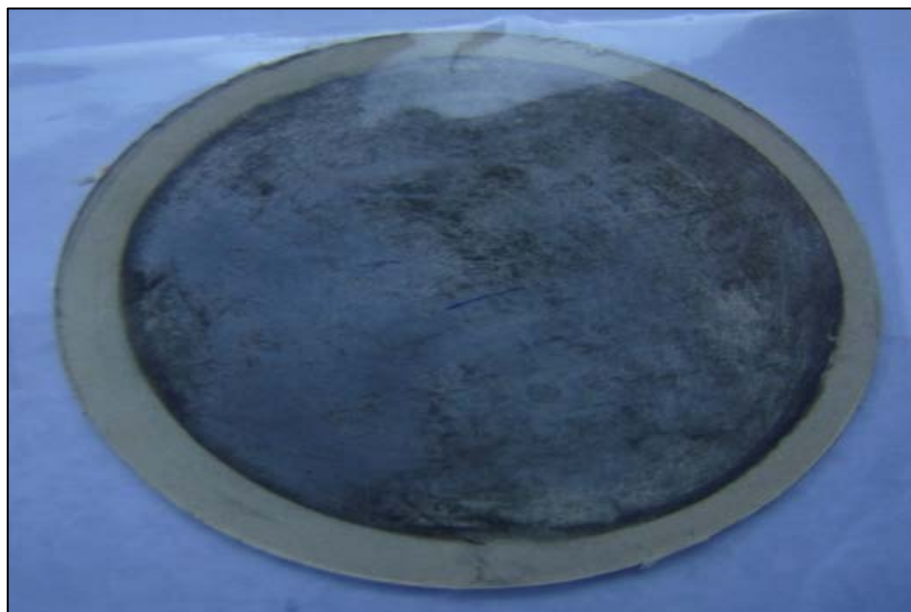
Figura 3.9 - Compósito metalizado e polarizado.
