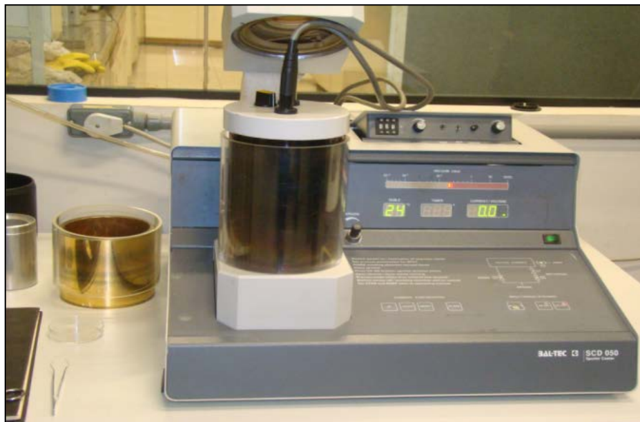
Figura 3.12 - Revestimento das amostras com carbono.
