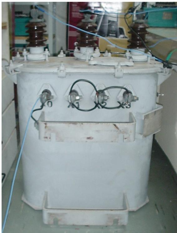
Figura 2.04 – Transformador de 15 kVA utilizado no experimento.
