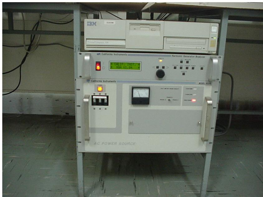
Figura 2.05 – Fonte de alimentação utilizada no ensaio.
