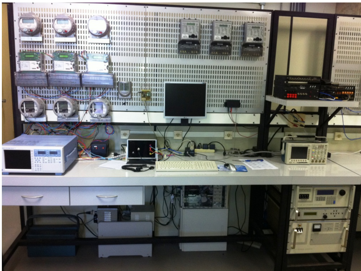
Figura 5.2 – Fotografia do sistema de medição e monitoramento para medidores eletrônicos de energia elétrica
