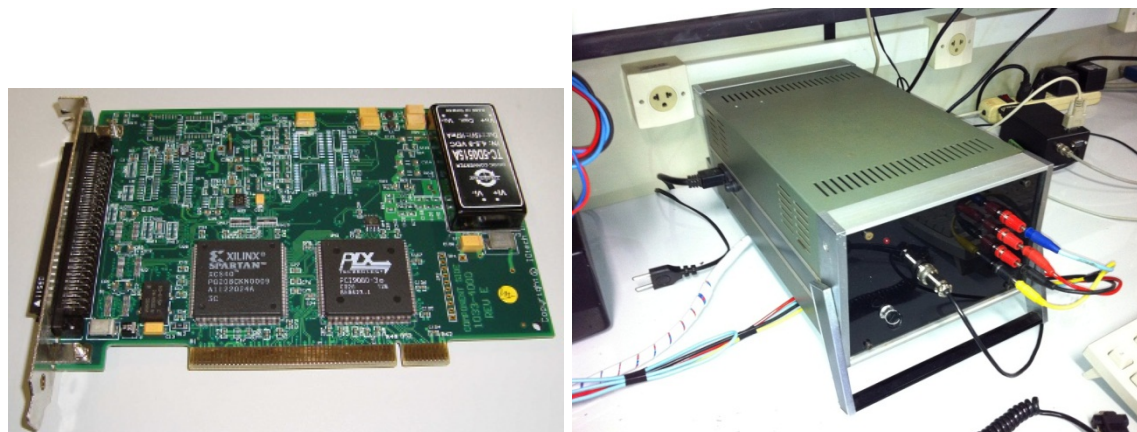
Figura 5.3: (a) Placa de geração de sinais com quatro canais controlada através de conexão PCI internamente ao PC e (b) apresenta o amplificador de tensão
