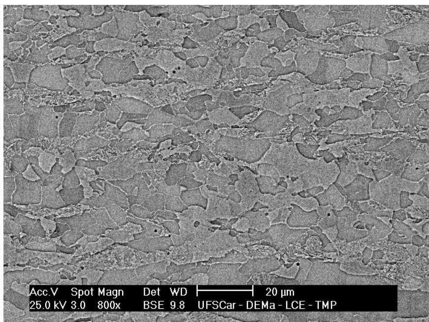
Figura 2. Microestrutura do material “como recebido” (Nital 2%).
