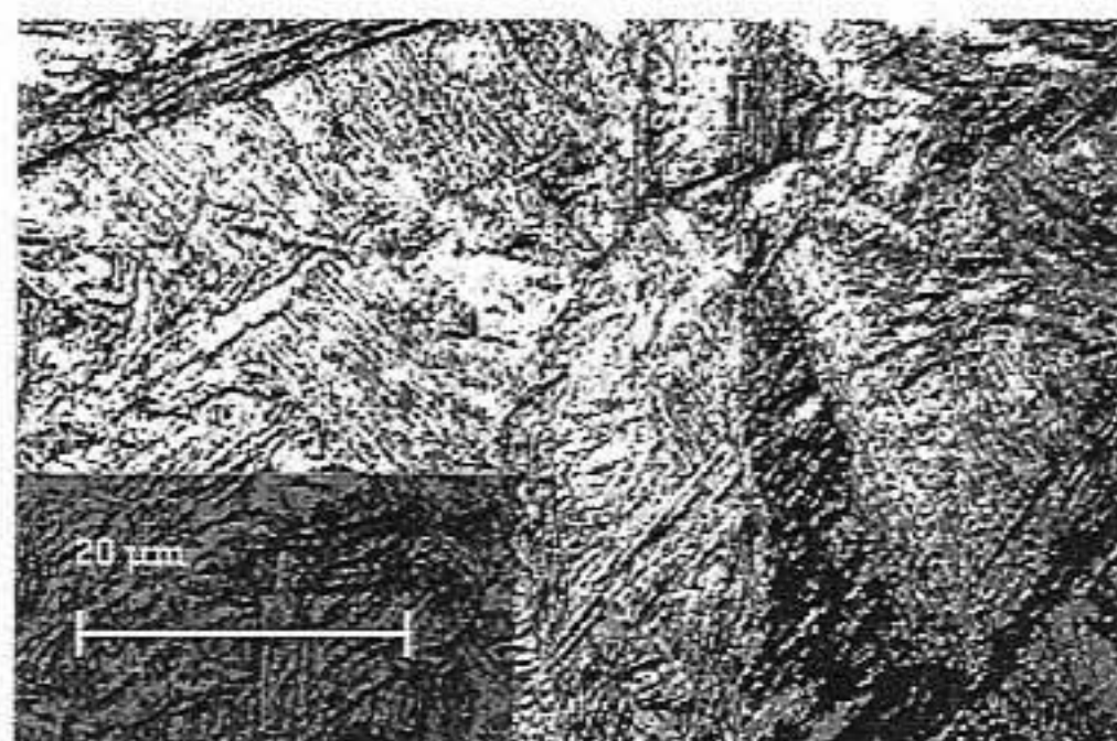
Figura 1: Ripas, blocos e pacotes de martensita observados na amostra temperada
