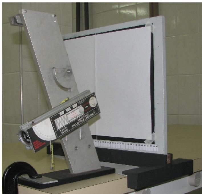
Figura 2 – Foto da montagem experimental para a realização do estudo do movimento em duas dimensões: Lançamento de projéteis.
