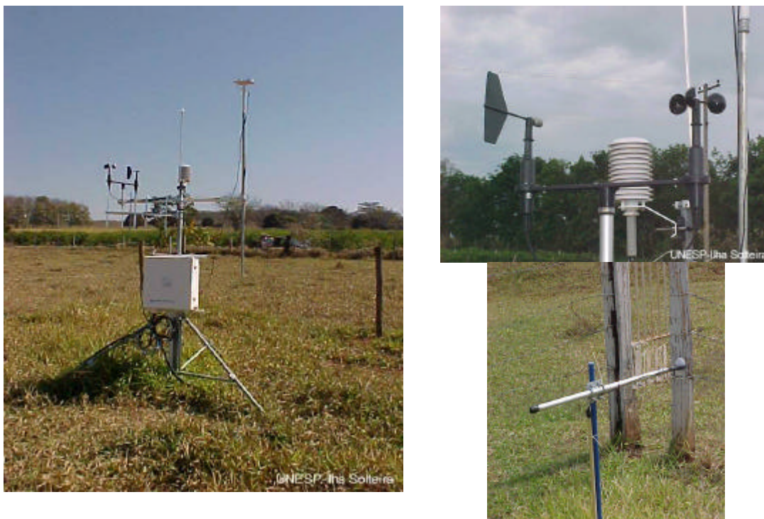
FIGURA 5 - Estação agrometeorológica automática e alguns sensores utilizados para estimativa da evapotranspiração de referência.
