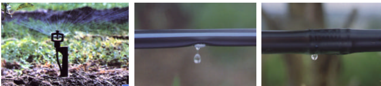
FIGURA 1 - Emissores para irrigação localizada: microaspersores, gotejadores e tubo-gotejadores.
