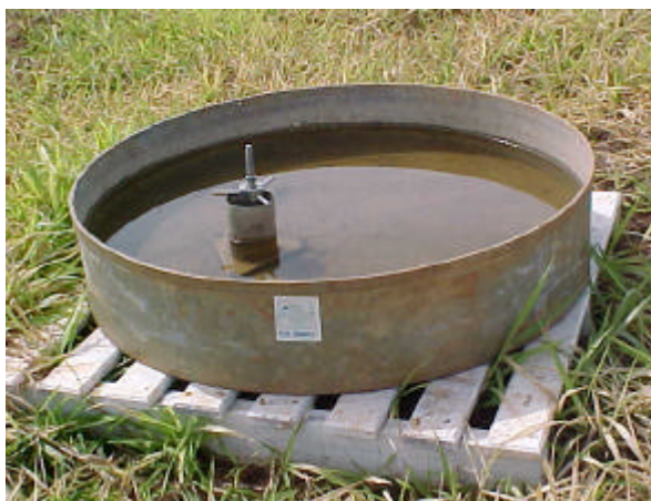
FIGURA 4 - Tanque Classe A, poço tranquilizador e parafuso micrométrico.
