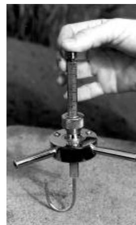
FIGURA 4 - Tanque Classe A, poço tranquilizador e parafuso micrométrico.
