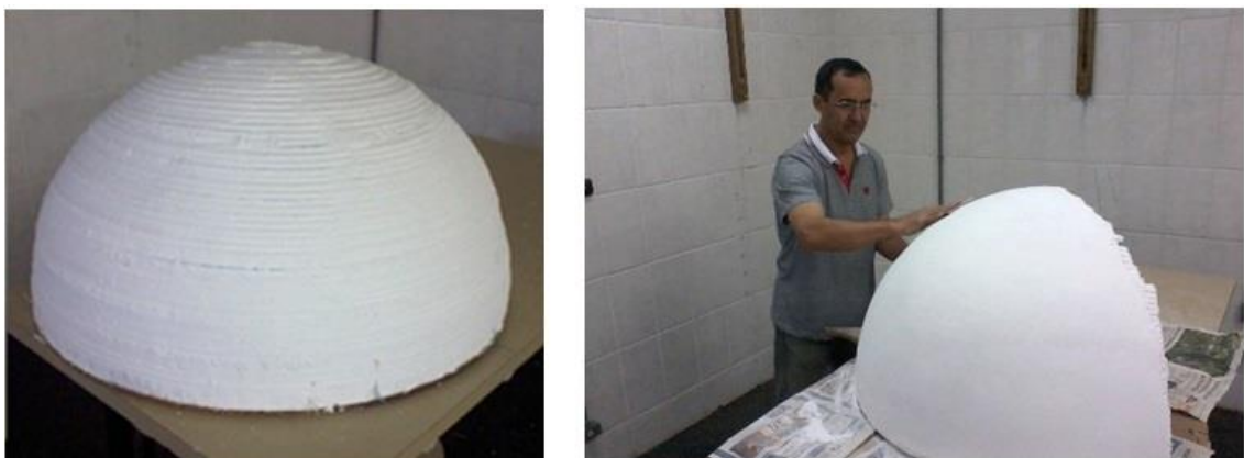
Figura 9: Fotografias da preparação e acabamento do molde em isopor e massa plástica para a construção dos hemisférios norte e sul celestes.
