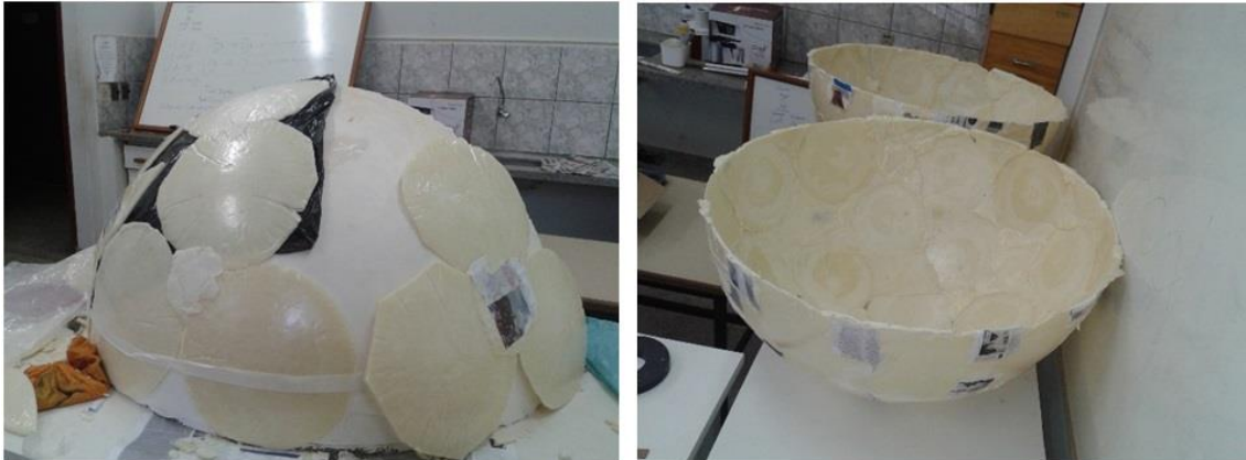
Figura 10: Fotografias das placas poliméricas moldando a superfície esférica do molde e os dois hemisférios completos.
