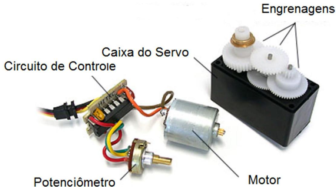
Fig. 1 – Componentes internos do Servo Motor.
