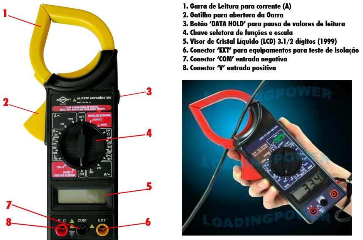
Figura 16: Multímetro digital com alicate amperímetro.
