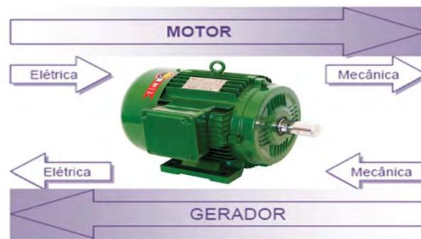
Fig. 1.1 – Conversão eletromecânica de energia.
