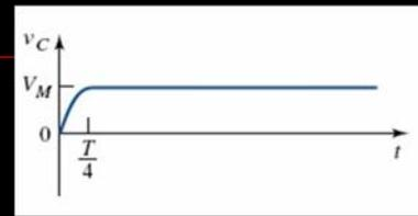
Após a tensão  $v_i$  atingir seu pico, ela começa a diminuir e o diodo torna-se reversamente polarizado (pois não pode conduzir corrente reversa). Como C não pode descarregar  $\Rightarrow v_c = v_i = V_M$  permanece indefinidamente.
