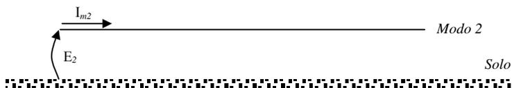
Figura 4.2 (b)- Representação do modo 2 de uma linha de n fases.
