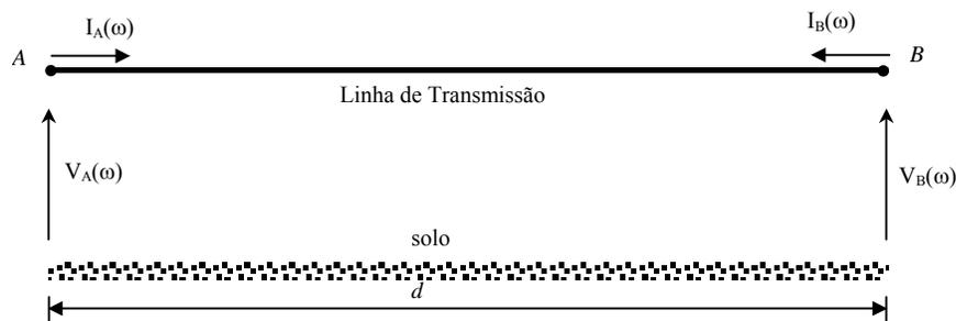
Figura 3.1 – Linha de transmissão monofásica de comprimento  $d$ .
