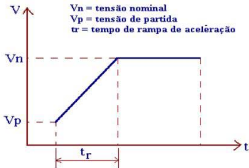
Figura 4 – Curva de aceleração de um MIT usando soft-starter
