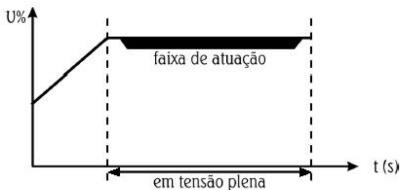
Figura 9 – Economia de energia usando um soft-starter
