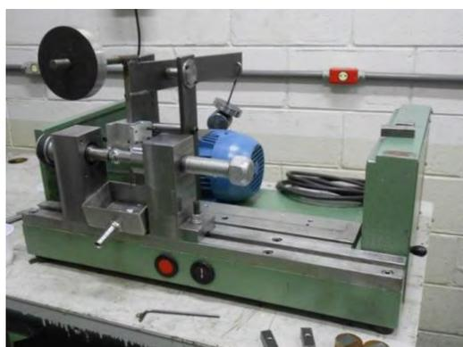
Fig. 1 – Equipamento de micro desgaste por esfera rotativa para os ensaios abrasivos.
