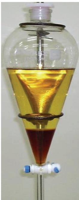
**Figura 3.8:** Processo de decantação do óleo de fritura pré-tratado e transesterificado utilizando metóxido de sódio.
