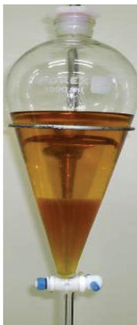
**Figura 3.4:** Processo de decantação do óleo de soja degomado transesterificado utilizando metóxido de sódio.
