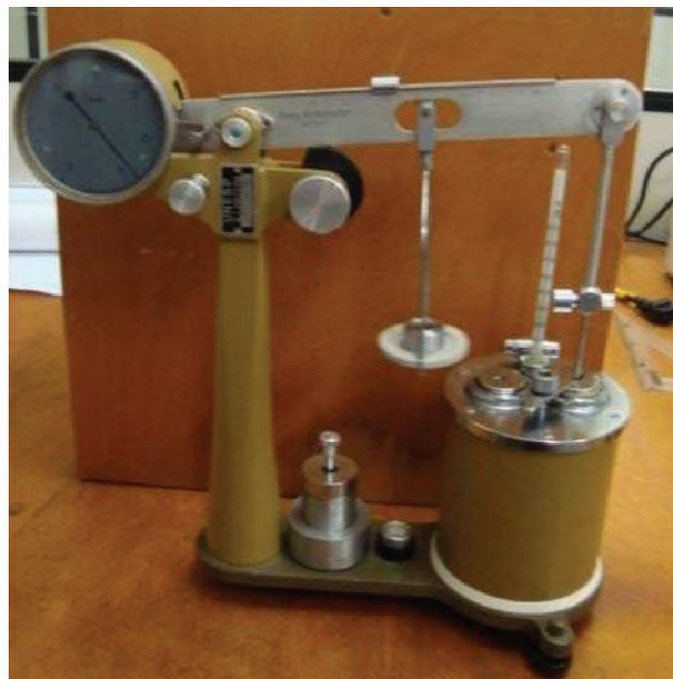
**Figura 3.16:** Equipamento utilizado para determinação da viscosidade.
