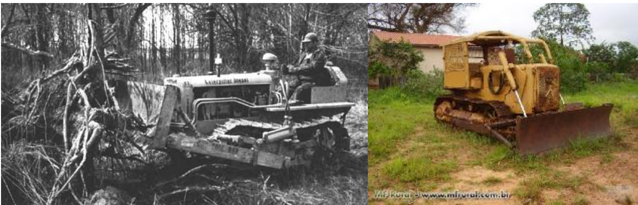
FIGURA 2. Enleiramento com lâmina convencional.
