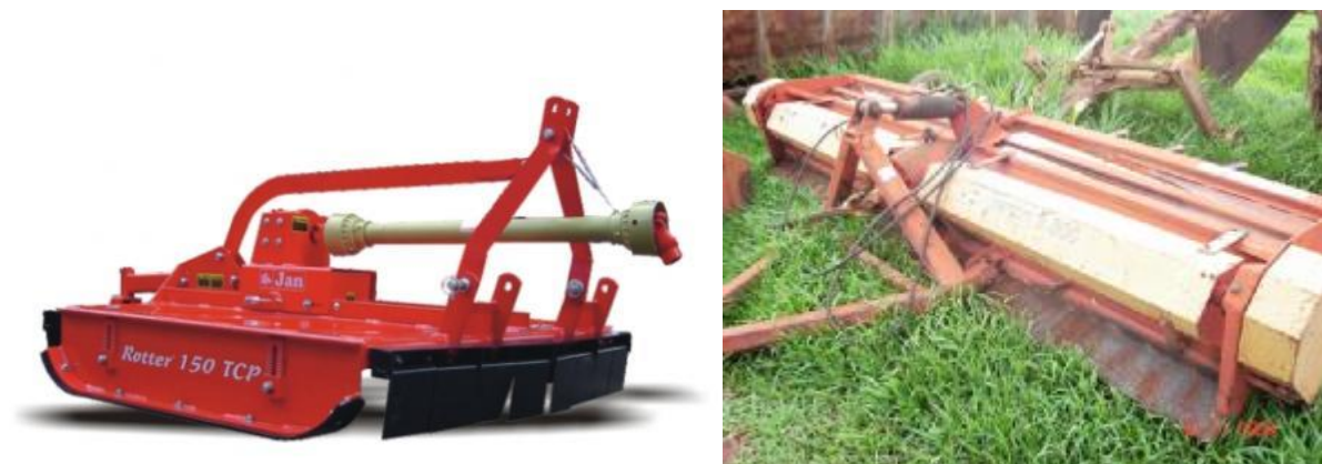
FIGURA 15. Exemplo de uma roçadora e de um triton, respectivamente.
