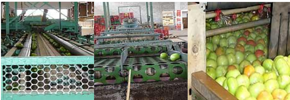
FIGURA 27. Roletes de Barras, esteira de lonas e a lavagem de frutos de tomate.
