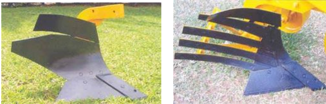
FIGURA 8. Aiveca “de uso geral” e recortada, respectivamente.
